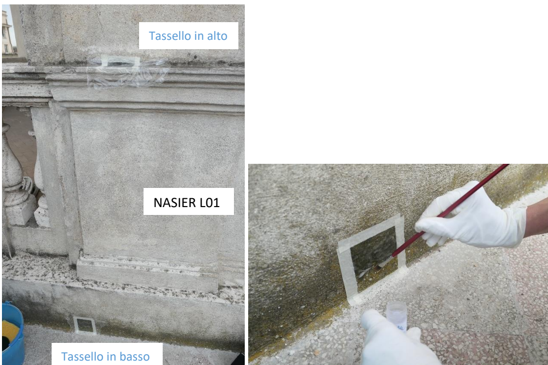
Figura 12 - Tasselli su Balastra dell’Altana, trattati con NASIER L01; a sinistra: particolare dell’applicazione in basso.
