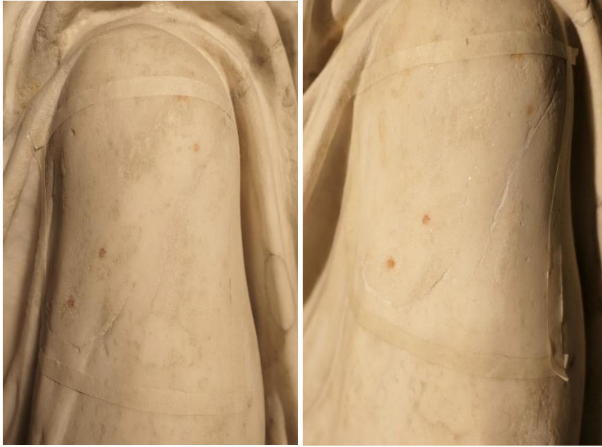
Figura 2- Tassello su statua di Calliope, inv. 8580; a sinistra: Prima del trattamento con MEK; a destra: dopo il trattamento.
