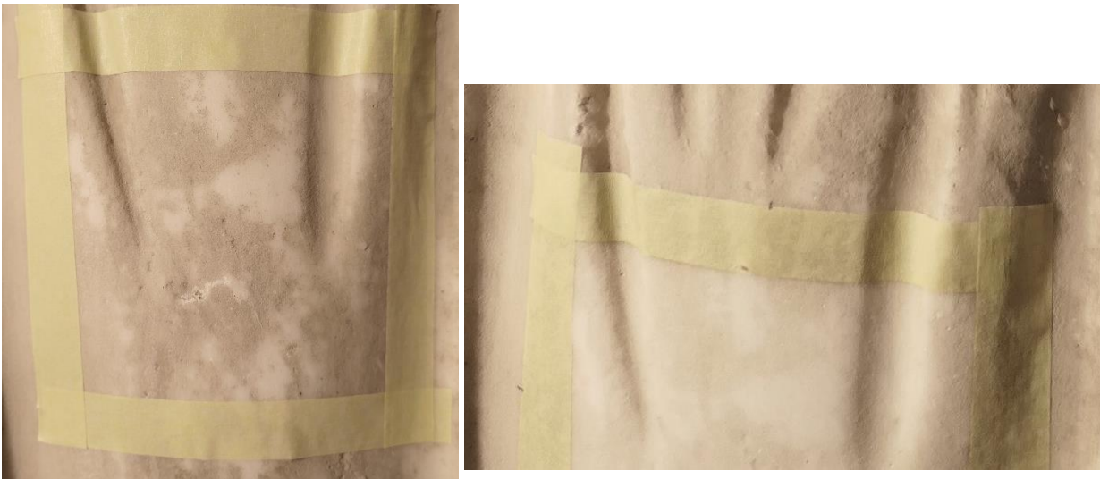
Figura 5 – Tassello su Erma di Atena, 8621; a sinistra: prima del trattamento con MEK; a destra: dopo il trattamento.
