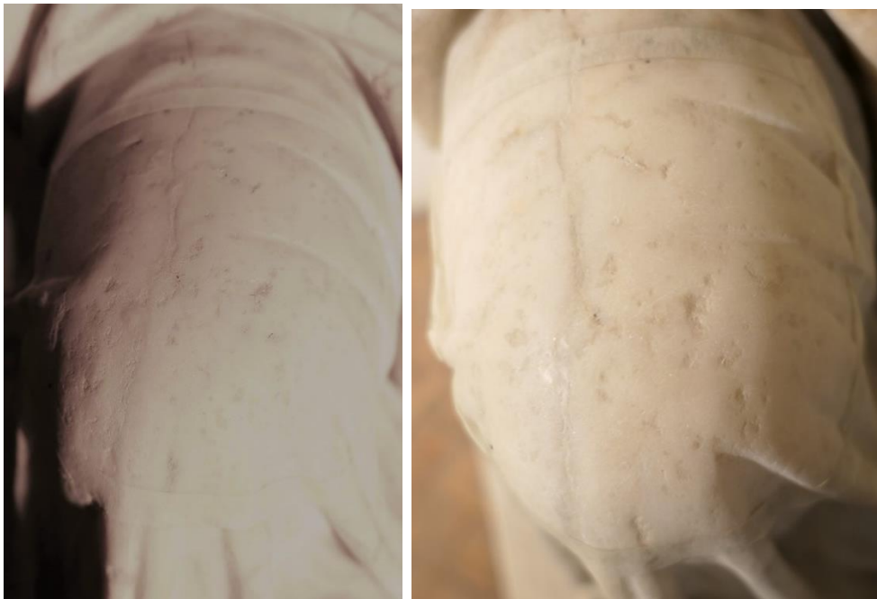
Figura 1 – Tassello su statua di Calliope, inv. 8580; a sinistra: Prima del trattamento con NASIER L02; a destra: dopo il trattamento, con tempo di applicazione 45 min.
