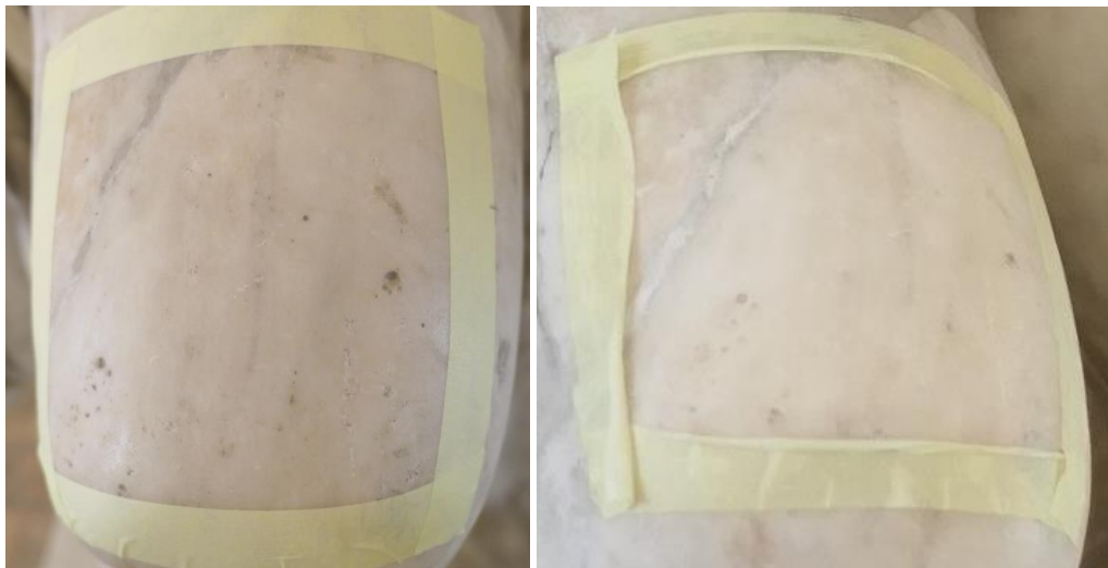
Figura 7 – Tassello su Statua di Apollo Citaredo, inv. 8594; a sinistra: prima del trattamento con NASIER L02; a destra: dopo il trattamento, con tempo di applicazione di 45 minuti.
