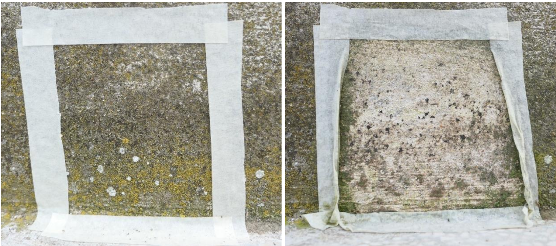
Figura 11 - Tassello A2 su Balastra dell’Altana in basso; a destra: prima del trattamento con NASIER L01; a destra: dopo il trattamento, con tempo di applicazione di 85 minuti.
