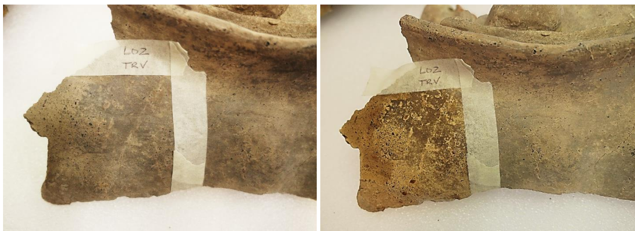
Figura 16 – Tassello TrV: Terracotta votiva. Inv. 14609, a sinistra: prima del trattamento; a destra: dopo il trattamento con L02 per 30 minuti (superficie non ancora completamente asciutta).
