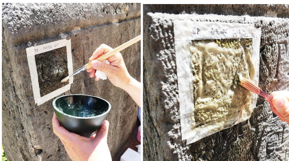
Figura 9 - Tassello EP: a sinistra: applicazione del prodotto L01; a destra: rimozione del prodotto L01.
