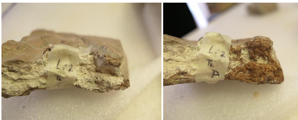
Figura 14 – Tasselli TR (A): Teracotta Inv. 598029, a sinistra: prima del trattamento; a destra: dopo il trattamento con L02 per 30 minuti.
