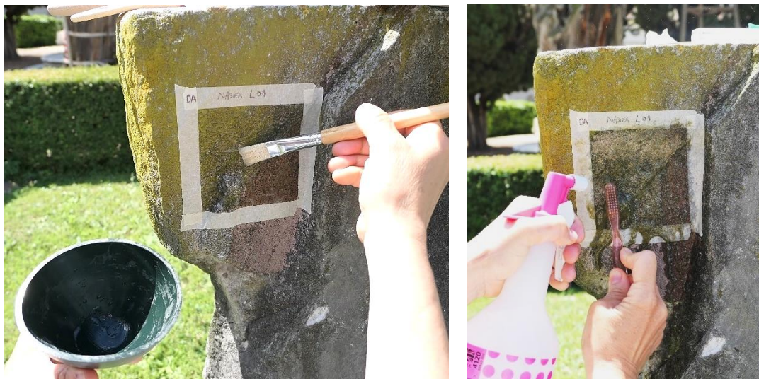
Figura 7 – Tassello DA: a sinistra: applicazione del prodotto L01; a destra: rimozione del prodotto L01.
