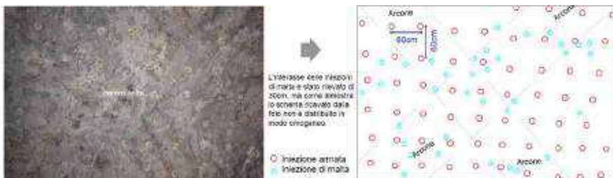
Figura 4.1.4.2 Ricostruzione della distribuzione delle due tipologie di iniezioni.
