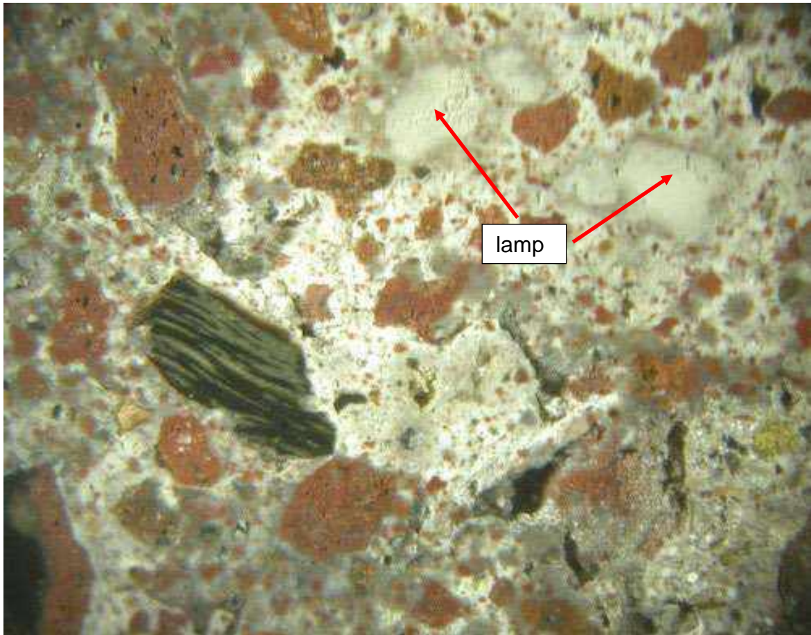
Foto4 – campione A3 – legante – sezione lucida – luce riflessa – 10 x
