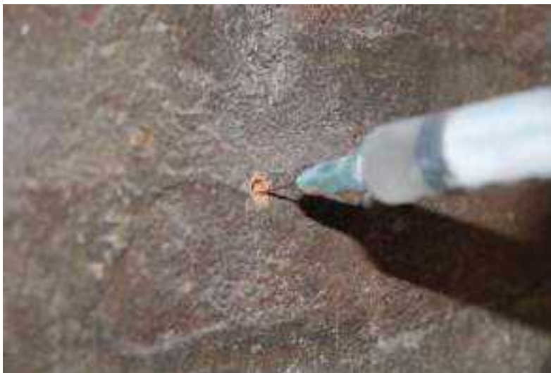
Figura 3.3.1.5 – Inserimento del gel conduttivo con siringa
