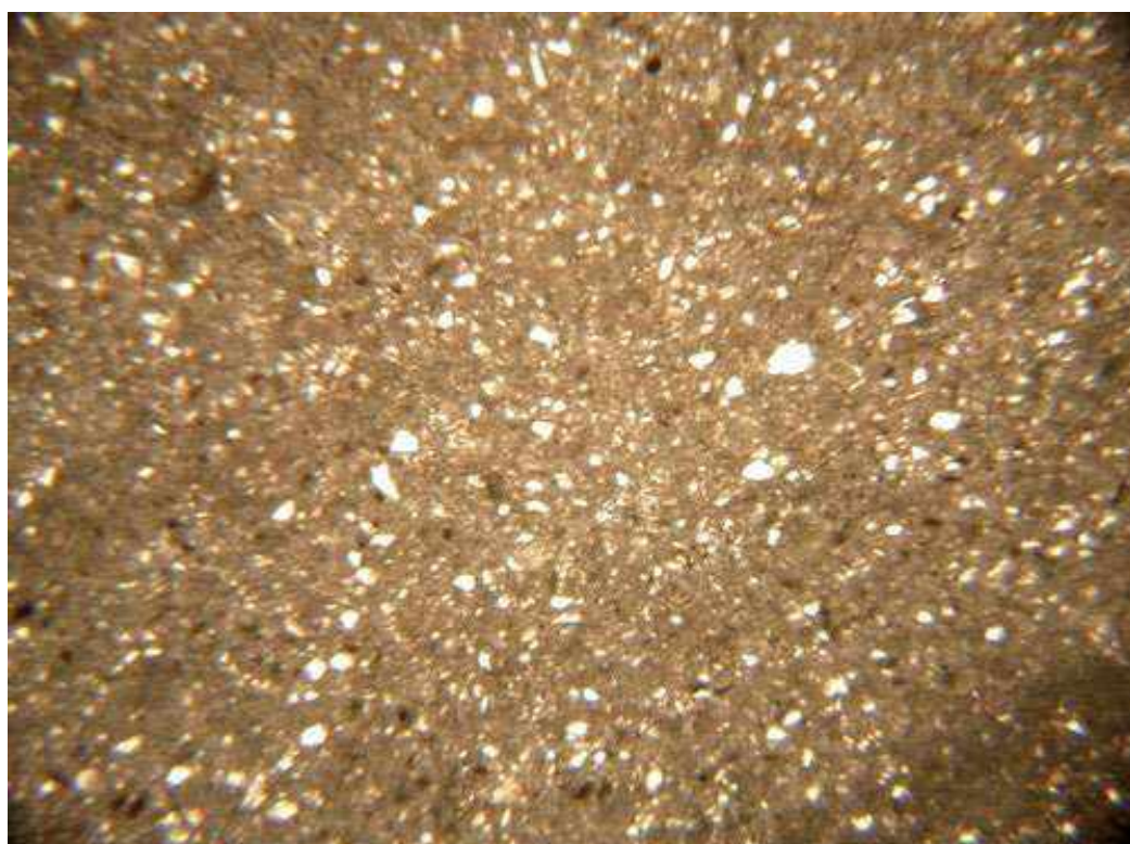
Foto29 – campione M3 – aggregato – sezione sottile – luce trasmessa – nicol// - 35 x
