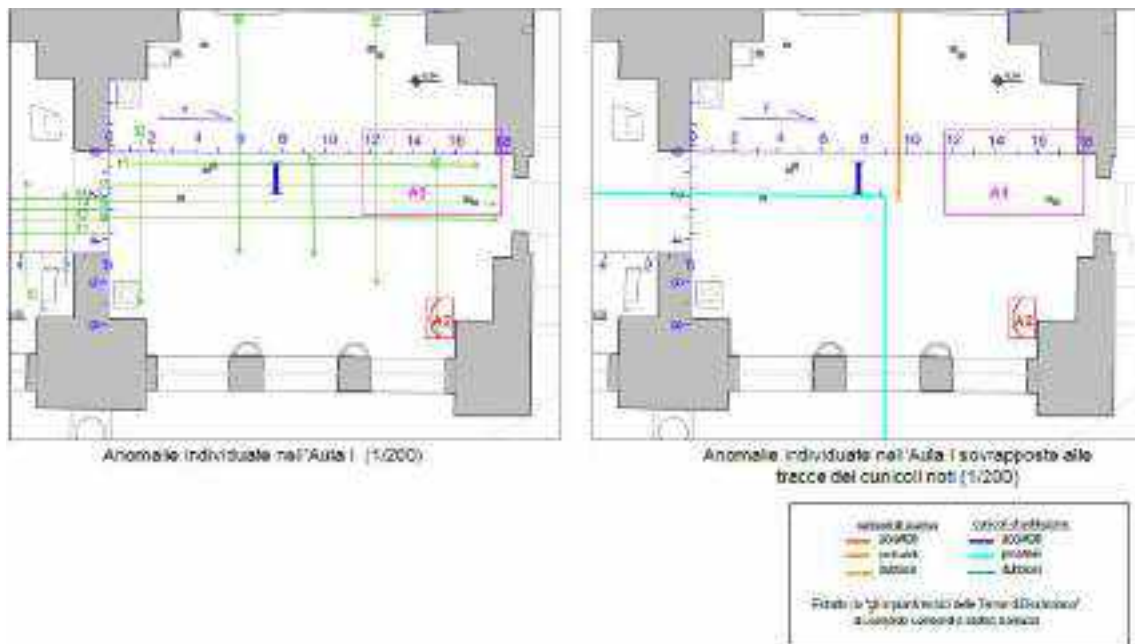
Figura 4.2.9 – Planimetria dell'Aula I con sezioni GPR, anomalie di interesse e le tracce dei cunicoli noti.
