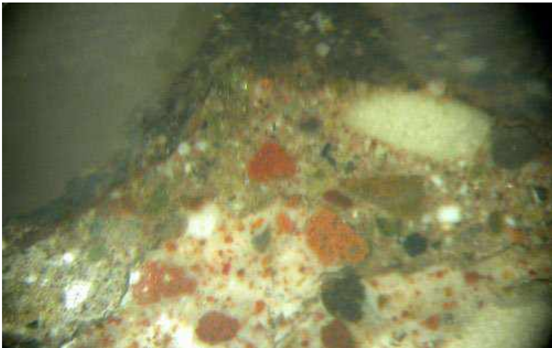
Foto7 – campione A3 – strato superficiale – sezione lucida – luce riflessa – 20 x
