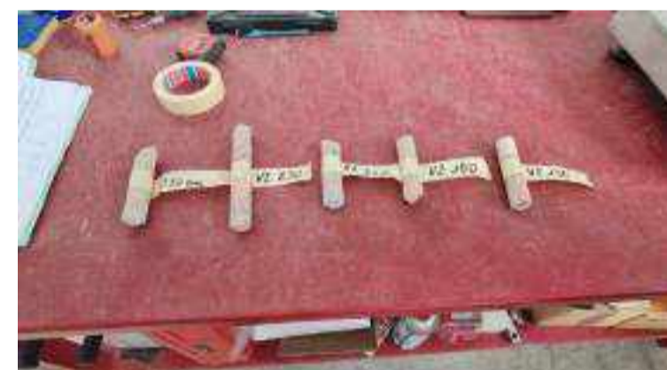
Campioni prelevati dal microcarotaggio sottoposti a prove di schiacciamento
