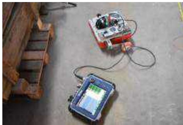
Figura 3.1.1 – Strumentazione utilizzata per le indagini radar sui pilastri: antenna multifrequenza 300-800 MHz collegata allo strumento di acquisizione SIR 4000
