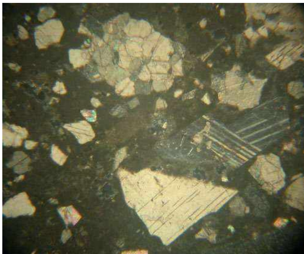
Foto24 – campione B1-2 – aggregato – sezione sottile – luce trasmessa – nicol+ - 35 x
