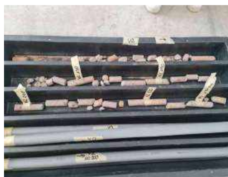
Campioni prelevati dal microcarotaggio sottoposti a prove di schiacciamento
