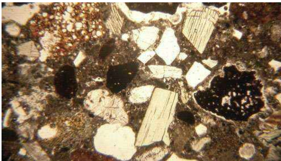
Foto8 – campione A3 – strato superficiale – sezione sottile – luce trasmessa – nicol// - 35 x
