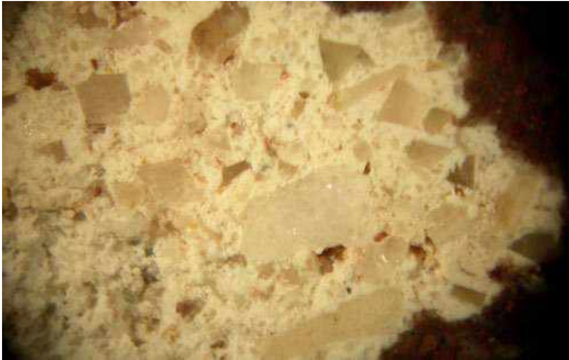
Foto22 – campione B1-2 – aggregato – sezione lucida – luce riflessa – 10 x
