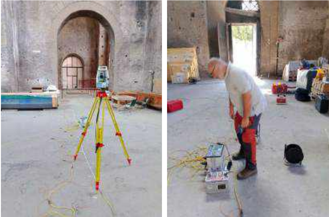
Figura 2.2.1.3: Resistivimetro digitale Syscal-Pro96 e stazione totale TS15 in fase di acquisizione dati di tomografia elettrica 2D.
