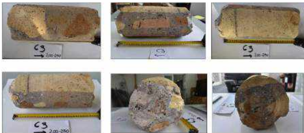
Figura 4.3.1.8 Dettaglio della carota C3, asciutta e compatta, senza vuoti, con caementa stratificati in modo regolare secondo una direzione prevalente.
