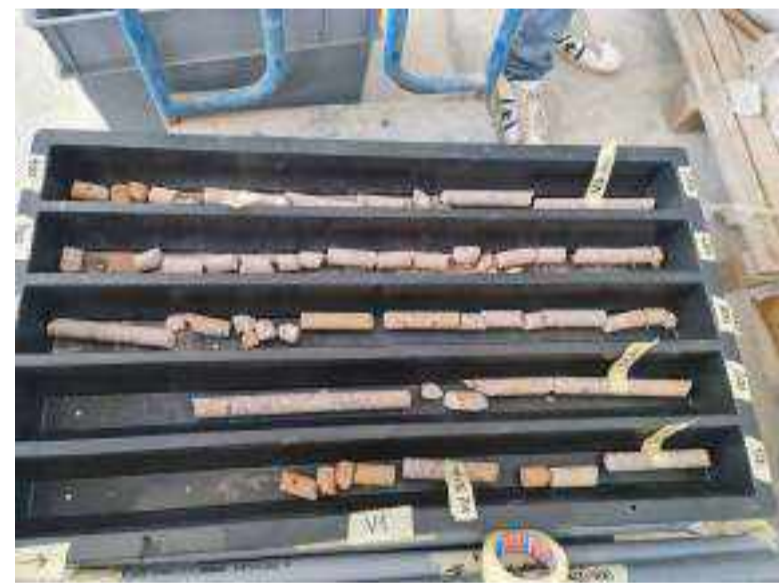
Campioni prelevati dal microcarotaggio sottoposti a prove di schiacciamento
