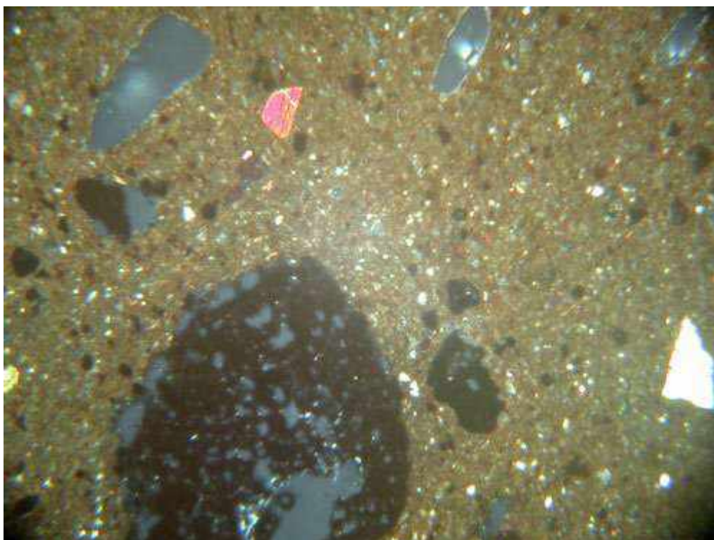
Foto48 – campione M7 – aggregato – sezione sottile – luce trasmessa – nicol+ - 35 x
