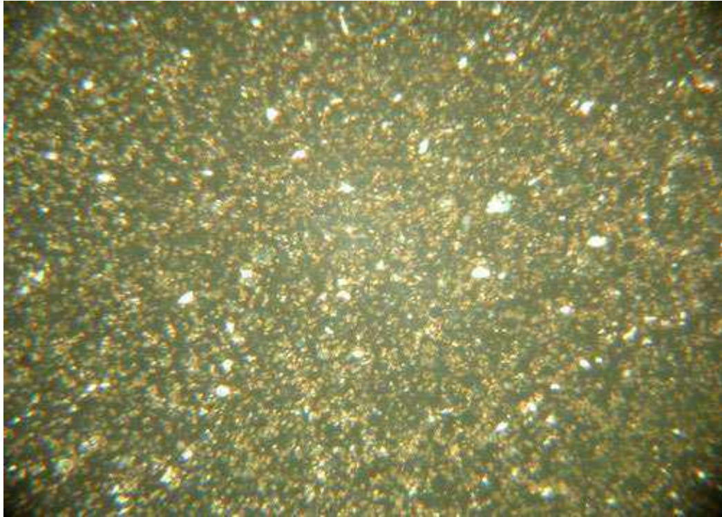
Foto30 – campione M3 – aggregato – sezione sottile – luce trasmessa – nicol+ - 35 x
