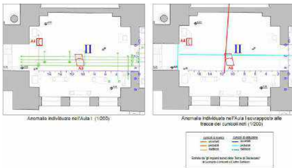
Figura 4.2.11 – Planimetria dell'Aula II con sezioni GPR e con sovrapposte le anomalie di interesse e le tracce dei cunicoli noti, in ciano e rosso.
