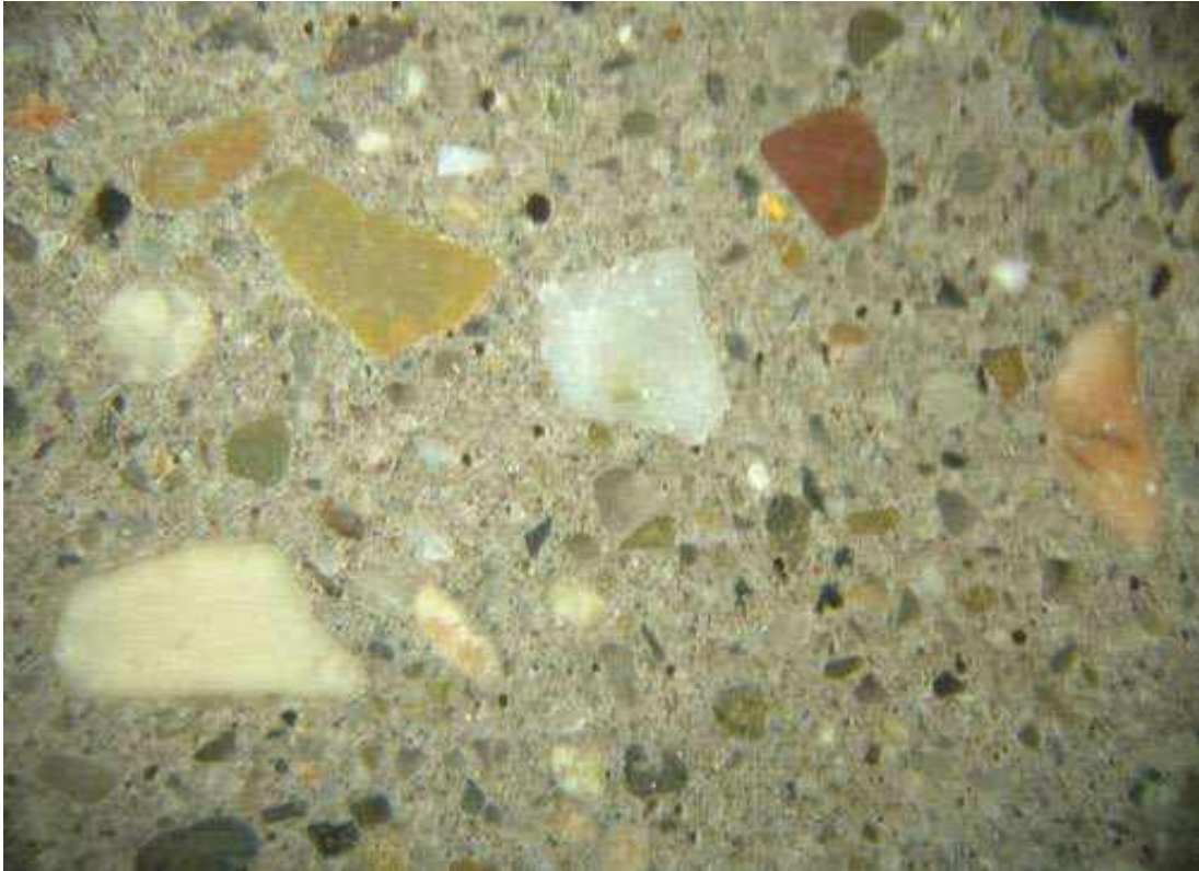
Foto10 – campione A4 – legante – sezione lucida – luce riflessa – 10 x
