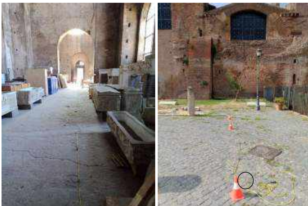
Figura 2.2.1.1.: Elettrodi, morsetti e cavi conduttori utilizzati per la realizzazione della tomografia elettrica 3D (a sinistra) e 2D (a destra) alle Terme di Diocleziano.
