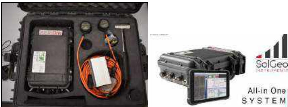
Fig. 3.2.2. Strumentazione per indagine sonora, modello All-In One.
